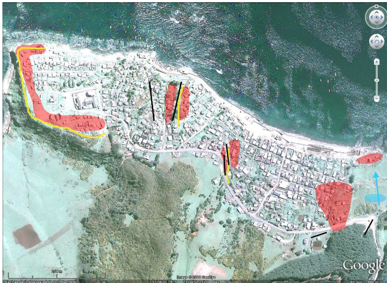
Figura 2: Imagen satelital (Google Earth) del sector de punta Lavapié. Las líneas negras representan grietas mayores observadas en el sector. Líneas amarillas representan escarpes pronunciados que representan un peligro para las viviendas cercanas, tanto en su cabecera (arriba) como a sus pies (abajo). Flecha azul representa la dirección de un drenaje natural que podría seguir un aluvión en el caso del colapso de la copa de agua norte, y que afectaría directamente a unas instalaciones cerca de la costa. Elipse celeste indica sector con presencia de agua superficial. Los polígonos rojos se identifican como áreas de riesgo por su cercanía a escarpes y, en algunos casos, el desarrollo de grietas como potenciales antecedentes de remociones en masa y/o deslizamientos.
