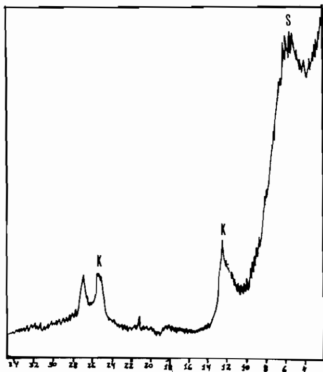
FIG. 3. (4) Difractograma de la muestra No. 57 mostrando la variación de intensidad del pick de la Esmeclita (S).
