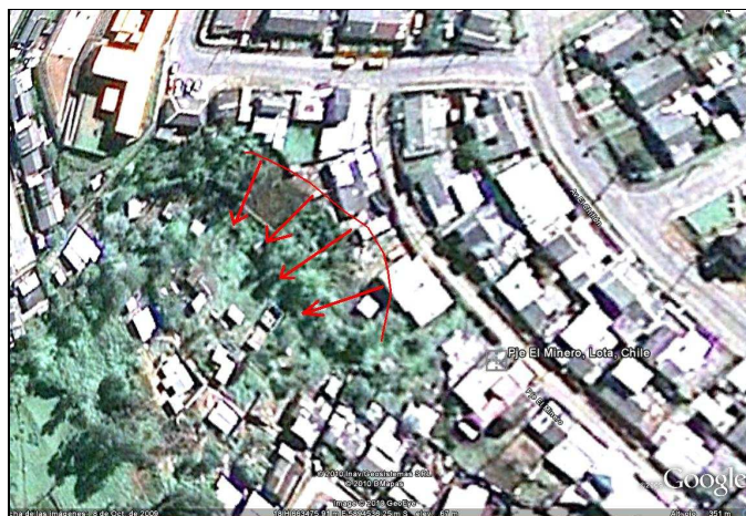
Figura 9: Indica la dirección de desplazamiento de terreno hacia la quebrada, en Pje. El Minero de Villa los Héroes.
