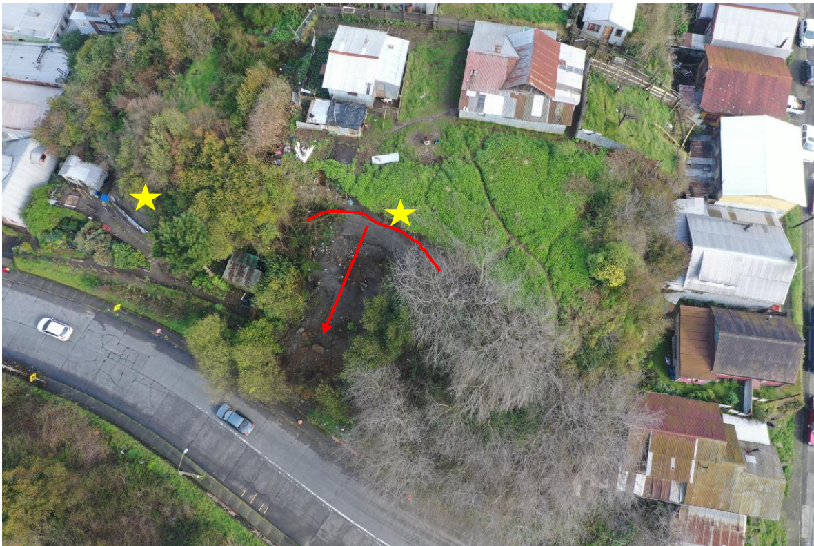
Figura 9. Imagen Dron del deslizamiento del 1 de agosto de 2023. En línea roja se muestra el escarpe de la remoción en masa y la flecha roja indica la dirección de movimiento. Se representa, además, en estrella amarilla la ubicación de bloques colgantes de arenas y cornisas que pueden colapsar en un futuro cercano.
