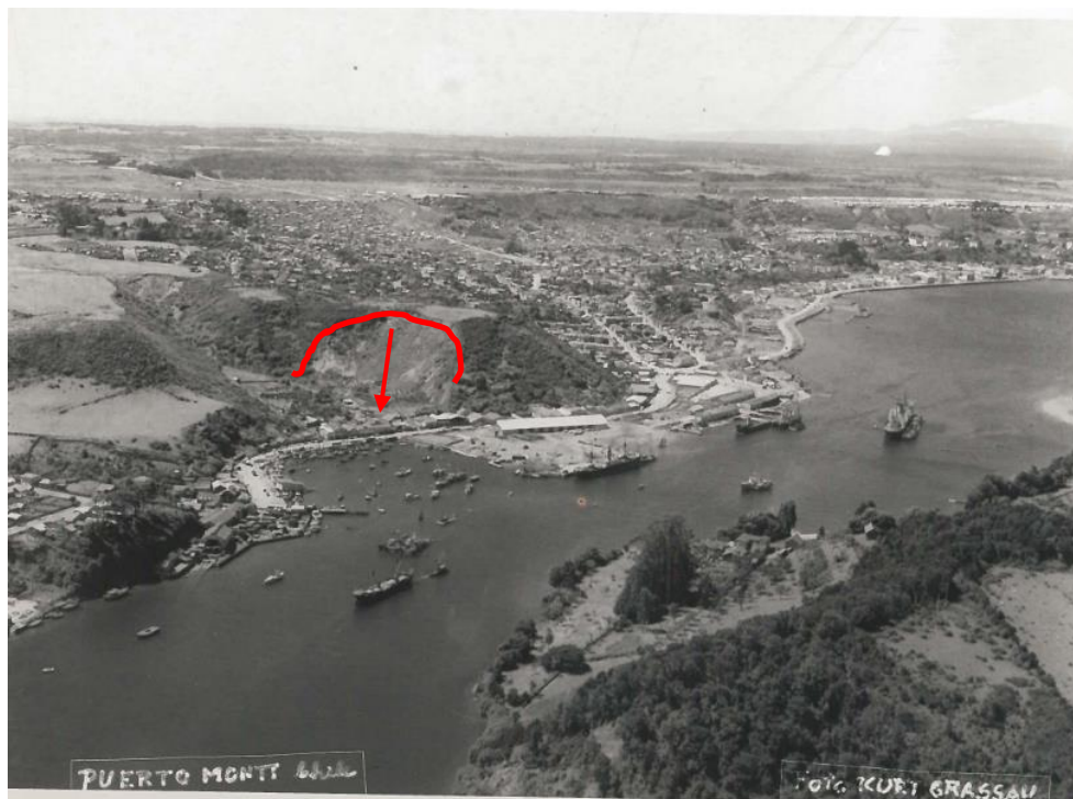
Figura 6. Fotografía aérea del área del sector portuario (Kurt Grassau, 1962. Gentileza de E. Olsen viuda de Grassau, facilitada a SERNAGEOMIN con fines educativos y científicos). Se distingue, a la izquierda de la fotografía, remoción en masa ocurrida en el invierno de 1957 en Ladera Angelmó. En línea roja se muestra el escarpe de la remoción en masa y la flecha roja indica la dirección de movimiento.
