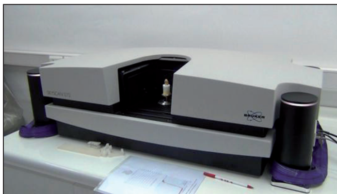
Figura 1. Sistema de microtomografía de alta energía Skyscan/Bruker, modelo 1272.
