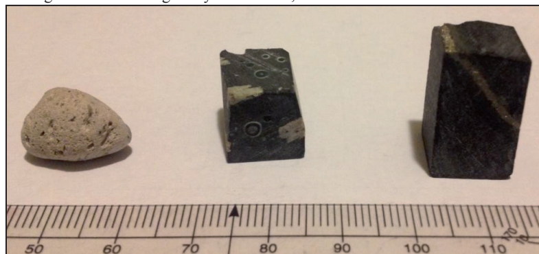
Figura 2. Muestras analizadas. De izquierda a derecha: pómez, andesita amigdaloidal y pórfido andesítico. Escala en centímetros.
