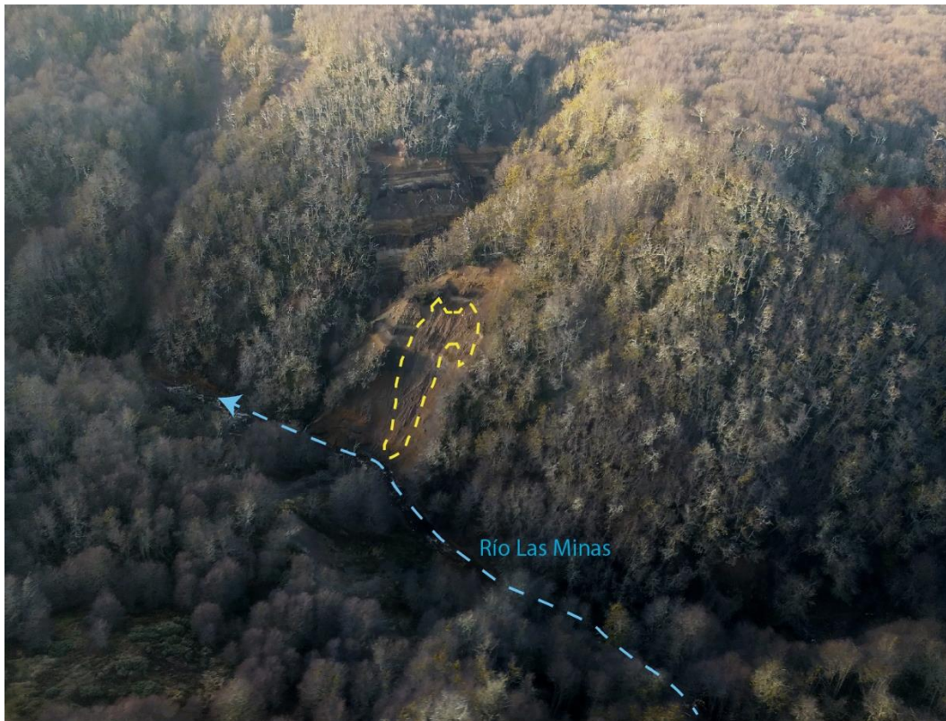
FIG. 12. Cárcavas incipientes en laderas por escorrentía superficial (en amarillo), sin evidencia de remociones. Sector Garganta Alta, ladera Sur, fotografía tomada en sobrevuelo del 05/06/2020.
