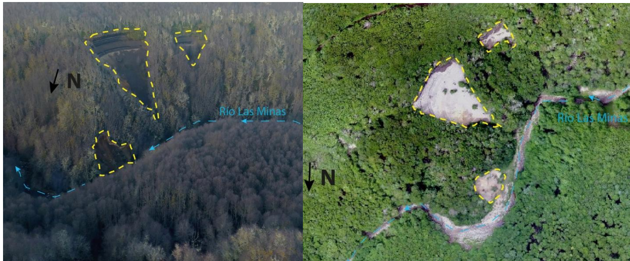
FIG. 11. Zonas con evidencia de escorrentía superficial, pero sin evidencia de remociones en masa. A la izquierda, fotografía de sobrevuelo 05/06/2020; a la derecha, imagen aérea capturada con UAV el 12/12/2019.
