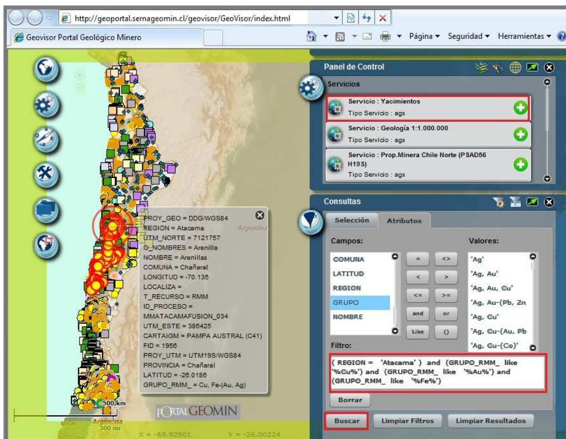
Figura 1: Ejemplo de selección de yacimientos en ambiente GIS a través de la herramienta de consulta del Geovisor del PortalGeoMin, provisto en internet por SERNAGEOMIN. La visualización representa la selección de los yacimientos de la Región de Atacama y que contuviesen Au, Cu y Fe entre sus Recursos. Los yacimientos que cumplen ésta condición se destacan automáticamente con un círculo rojo en el mapa, y es posible desplegar los atributos más relevantes de cada uno con una herramienta de identificación del Geovisor.
