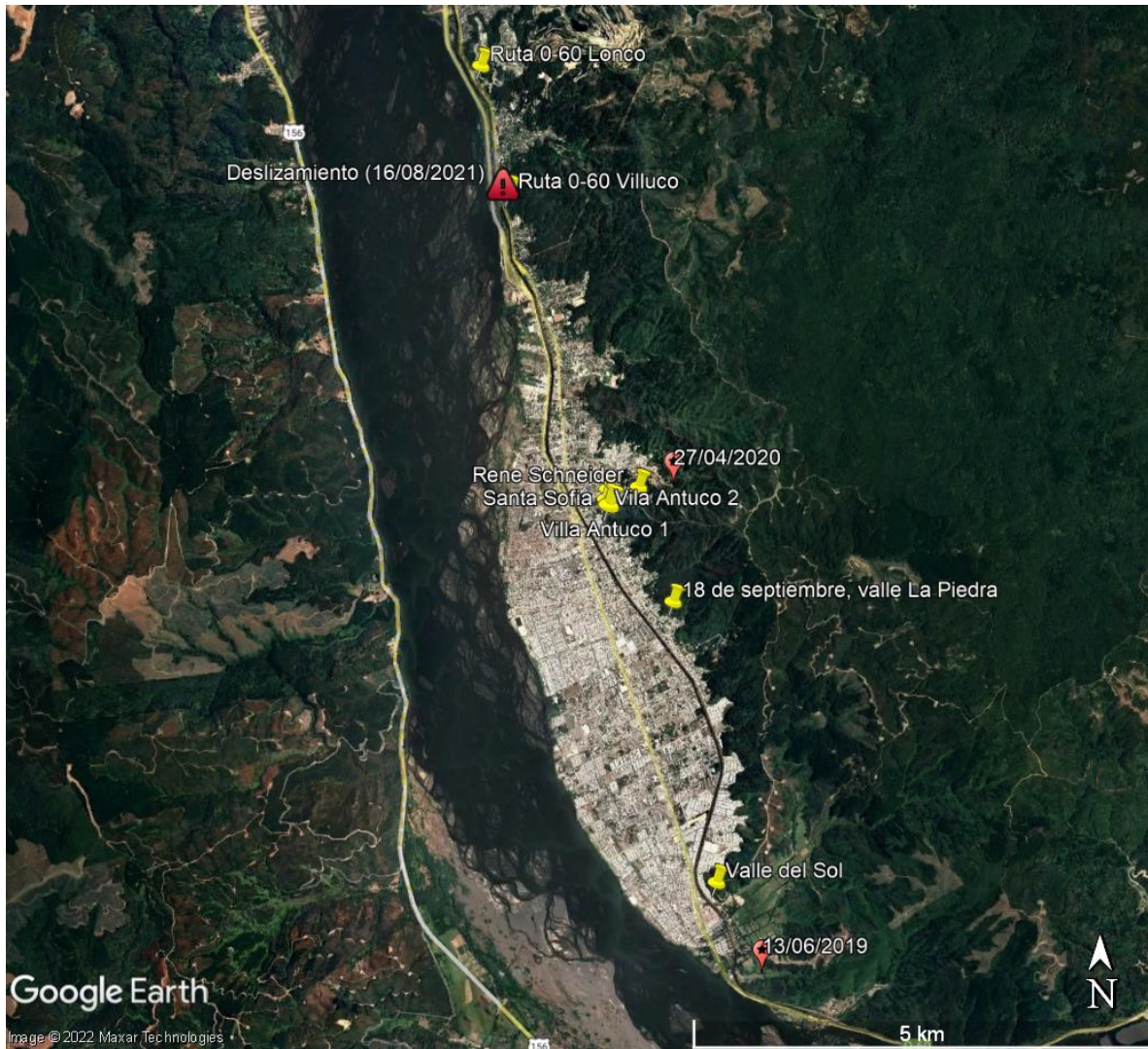
Fig. 7. Ubicación de remociones en masa históricas en comuna de Chiguayante (estrellas rojas), junto a puntos catastrados por la Unidad de Seguridad Ciudadana y Protección Civil como críticos dentro de la comuna (pines amarillos). Se identifica además el punto visitado por el deslizamiento ocurrido el 16 de agosto.
