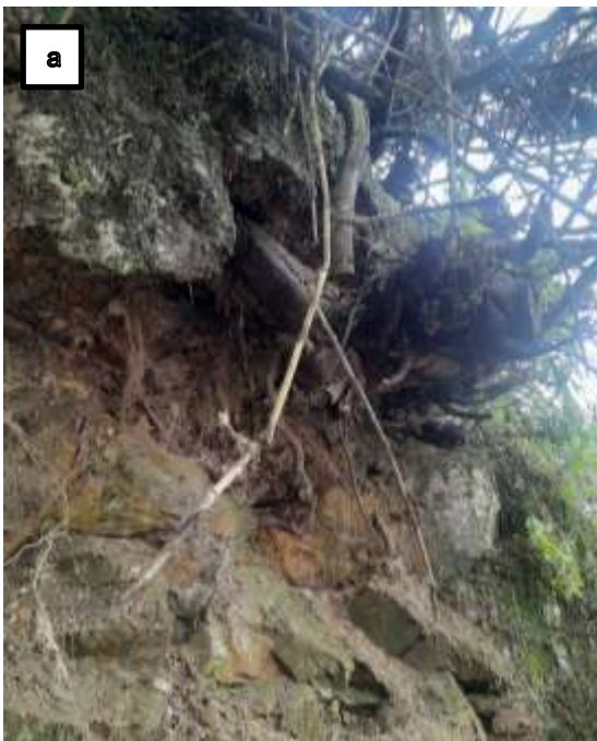
Fig. 3. a. Afloramiento rocoso directamente sobre casas afectadas. b. Detalle litología presente, correspondiente a filitas y esquistos de biotita, clorita y muscovita, de moderada a altamente meteorizadas.
