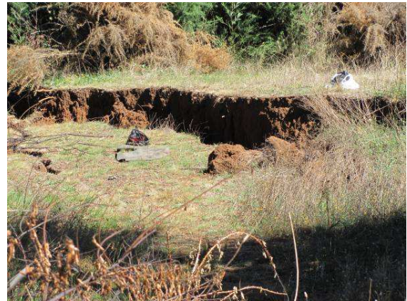
Figura 6. Cerro Colo Colo. Caso D. Grietas en parte alta del cerro. A) Grietas de tensión (flechas rojas) hundiendo el terreno entre ellas (flecha azul), la orientación de tipo de estructuras está en el rango N15E a N30E, lo que sugiere una extensión en sentido en sentido NW-SE (flechas blancas). B) escarpe generado por grieta N60E de importante apertura y desplazamiento vertical (~80 cm), descendiendo el bloque SE. Ubicación: UTM 5.876.285 N; 648.438 E (datum WGS84), 64m s.n.m.
