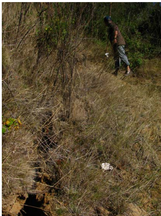
Fig. 7 Arauco, Villa Los Arrayanes. Grietas de tracción en cerro de las antenas que evidencian la formación de un deslizamiento.
