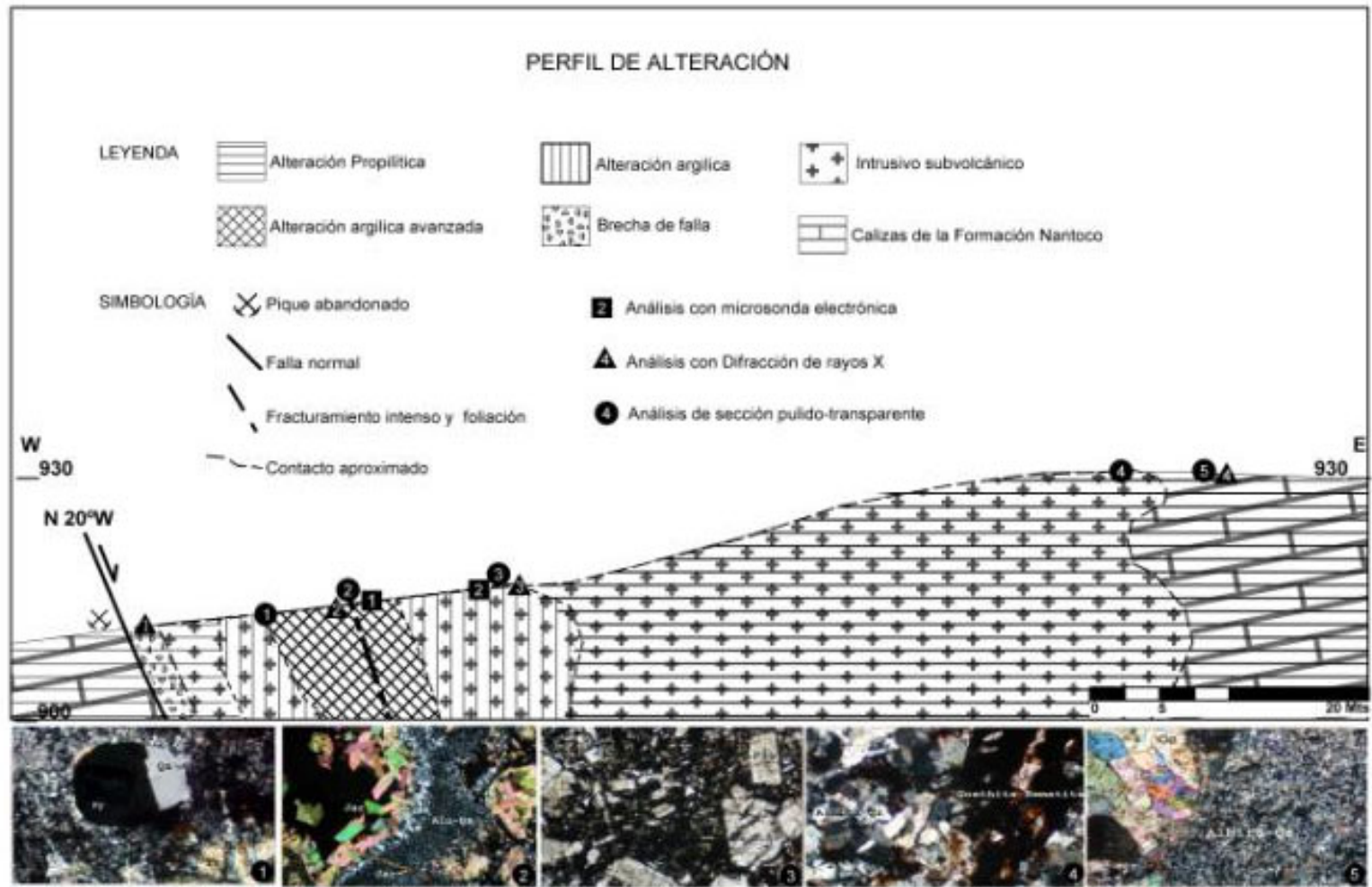
Figura 2. Perfil de alteración, muestra los análisis realizados y su distribución espacial respecto a las zonas de alteración. Abajo, fotomicrografías a nicoles cruzados magnificación 40X.
