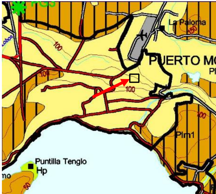
Figura 2. Extracto del mapa Geología básica y sitios propuestos de patrimonio geológico', (Antinao y otros, 2000). En el cuadrado negro, indicado por la flecha roja, se muestra la zona donde se ubica el muro de contención colapsado, en un sector compuesto por Depósitos glaciofluviales (Plgf1).
