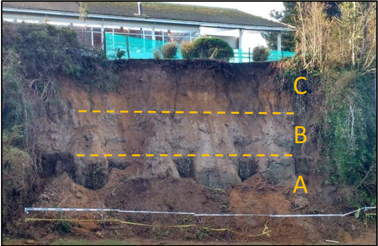
FIG. 5. Fotografía de la ladera afectada por la remoción en masa. De base a techo se observan 3 unidades diferenciadas, todas dispuestas en forma sub-horizontal. A: estrato de 3 m de potencia, compuesto de arena fina color pardo claro, con un grado medio a alto de compactación. B: estrato de 3 m de potencia, compuesto de arena limosa color pardo claro a gris, con un grado bajo a medio de compactación. C: estrato limo-arcilloso de coloración rojiza, de 3 m de potencia y con un muy bajo grado de compactación (material conocido informalmente como “cancagua”). Se observa desarrollo de suelo en su porción superior.
