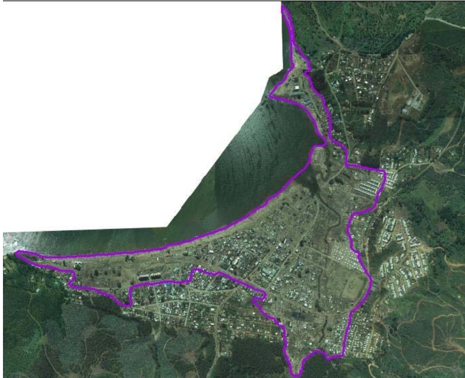
Fig. 1 Dichato. Imagen de fotografía aérea postsismo. Fotointerpretación del área de inundación del tsunami del 27/02/2010.
