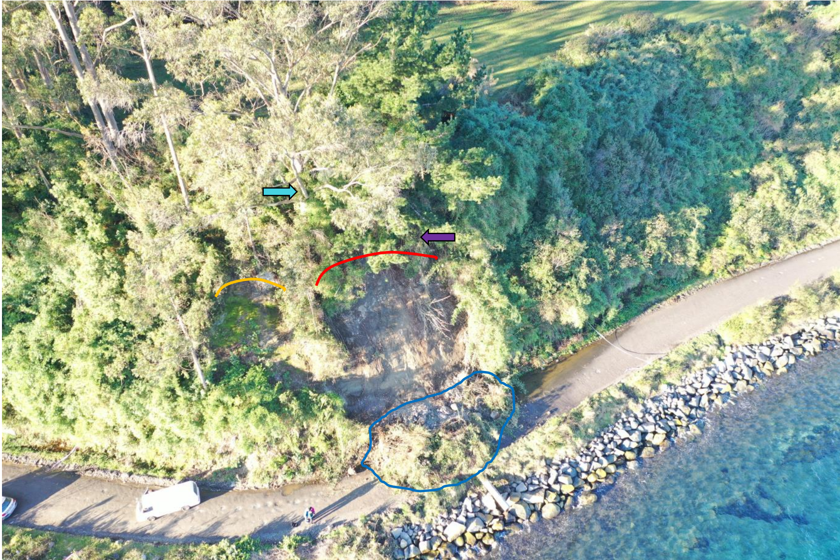
Figura 6. Imagen DRONE. Se observa corona (línea roja), escape, y depósito (delimitado por línea azul) de la remoción en masa del 21.07.20. Se representa, además: coronamiento de antigua remoción en masa (línea naranja); y se identifican grandes árboles de eucaliptus (flecha celeste) y pino (flecha morada) que ejercen carga sobre la ladera y que se recomienda retirar.
